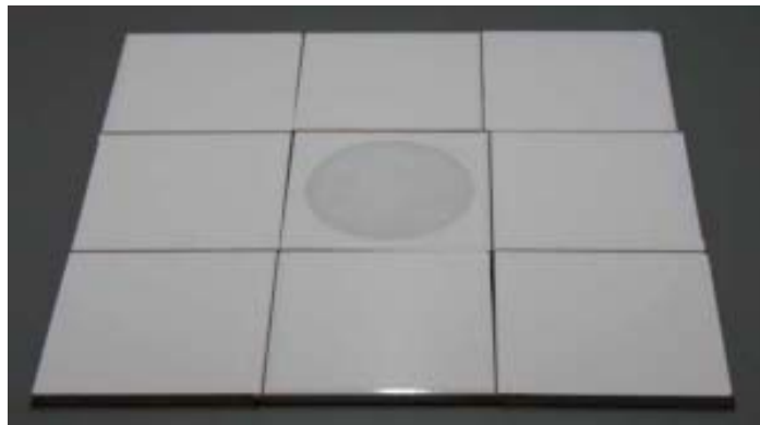
รูปที่ 8 การเปรียบเทียบกระเบื้องทดสอบที่ถูกขัดสีกับกระเบื้องชนิดเดียวกันที่ไม่ได้ถูกขัดสี
