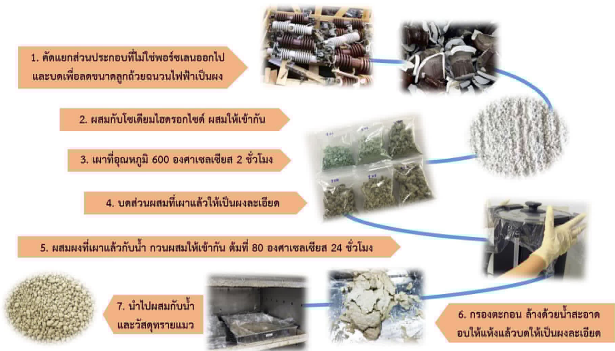
รูปที่ 2 ขั้นตอนการผลิตซีโอไลต์ในลูกถ้วยฉนวนไฟฟ้าในห้องปฏิบัติการ
