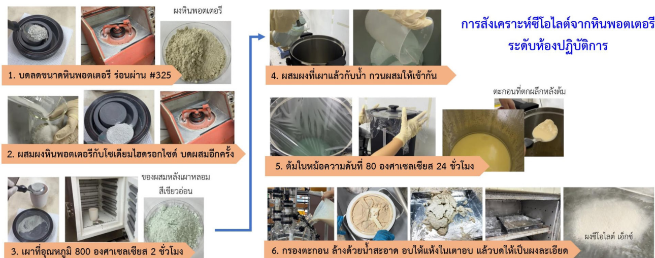
รูปที่ 1 ขั้นตอนการสังเคราะห์ซีโอไลต์จากหินพอตเตอร์ในระดับห้องปฏิบัติการ
