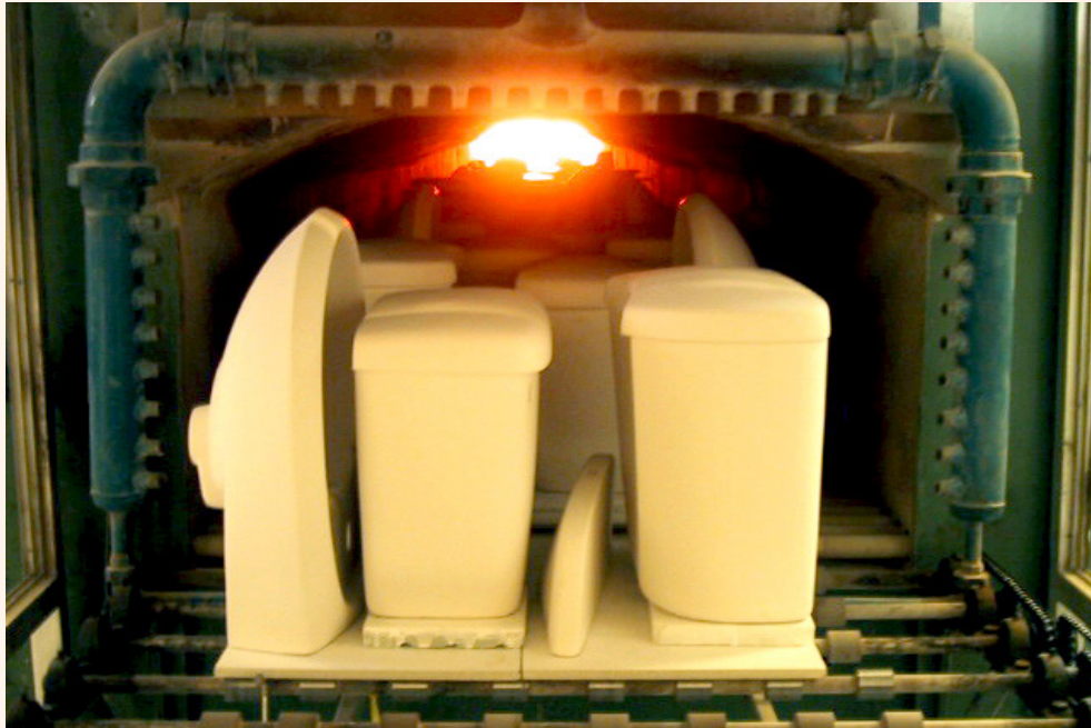
เตาโรลเลอร์ Noritake ตัวที่พัฒนาขึ้นมาสำหรับเผาเครื่องสุขภัณฑ์
