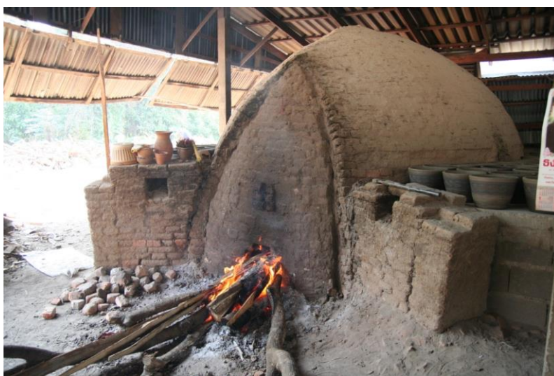
รูปที่ 4.7 เตาแมงป่องก่อด้วยอิฐดินดิบใช้ฟืนเป็นเชื้อเพลิง (ภาพถ่ายโดย ธนากร วาสนาเพียรพงศ์ ที่ชุมชนบ้านมอญ จังหวัดนครสวรรค์)
