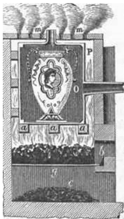
รูปที่ 4.17 เตาเผา (ซ้าย) เตาตะกรับโดนเปลวไฟโดยตรง (ขวา) เตาเผาแบบไม่สัมผัสเปลวไฟ
