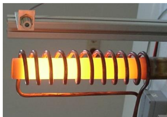
รูปที่ 11.7 ลักษณะการเกิดความร้อนของเตาเผาเหนี่ยวนำแม่เหล็ก
