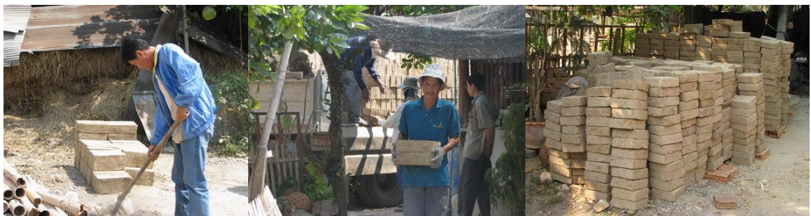
รูปที่ 13.2 สอนให้ชาวบ้านผลิตอิฐดินดิบสำหรับการก่อเตาเผาใช้เองได้
