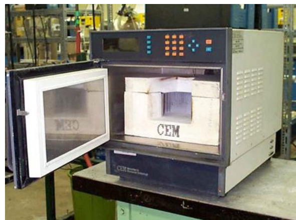
รูปที่ 11.3 ลักษณะการเผาด้วยเตาเผาไมโครเวฟ
