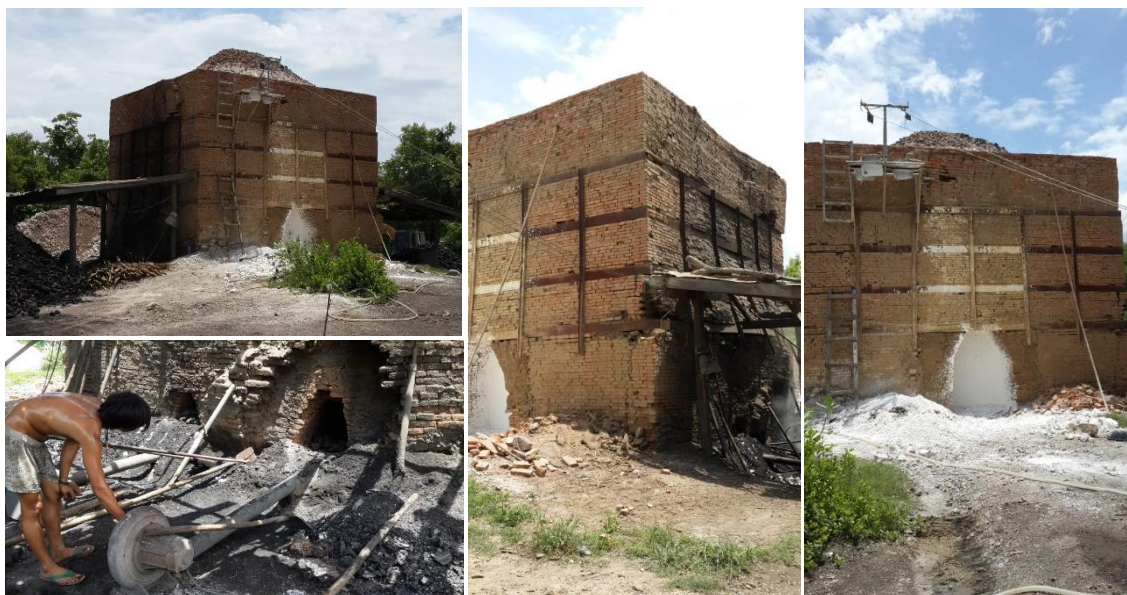
รูปที่ 4.14 เตาเผาปูนขาวรูปทรงสี่เหลี่ยมใช้ถ่านหินเป็นเชื้อเพลิงและใช้โบล์เวอร์เป่าอากาศ (ภาพถ่ายโดย ธนากร วาสนาเพียรพงศ์ ที่จังหวัดราชบุรี)
