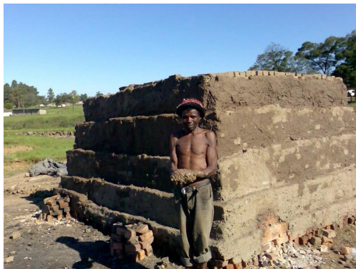
รูปที่ 2.6 การเผาเรียงกองพอกทับของโรงงานผลิตอิฐก่อสร้างดินเผาในประเทศ[10, 12]
