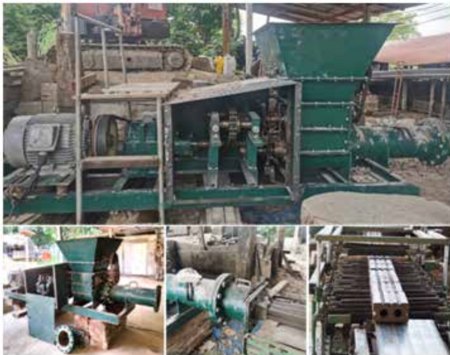
รูปที่ 5 เครื่องผลิตอิฐดินเผาก่อสร้างแบบชุดอัดเกลียวคู่ที่สร้างขึ้นในโครงการฯ
