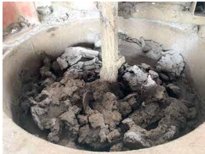
รูปที่ 4 ดินที่กำลังถูกกวนในถังกวนตำบลจัวราย อำเภออินทร์บุรี จังหวัดสิงห์บุรี
