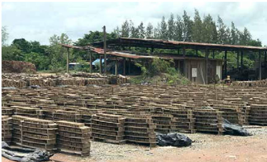
รูปที่ 7 การตากอิฐดิบกลางแจ้ง ตำบลจี่วราย อำเภออินทร์บุรี จังหวัดสิงห์บุรี
