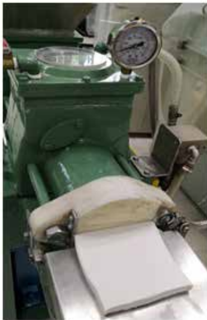
รูปที่ 11 การอัดรีดชิ้นงานผ่านเครื่องอัดรีดสูญญากาศ
