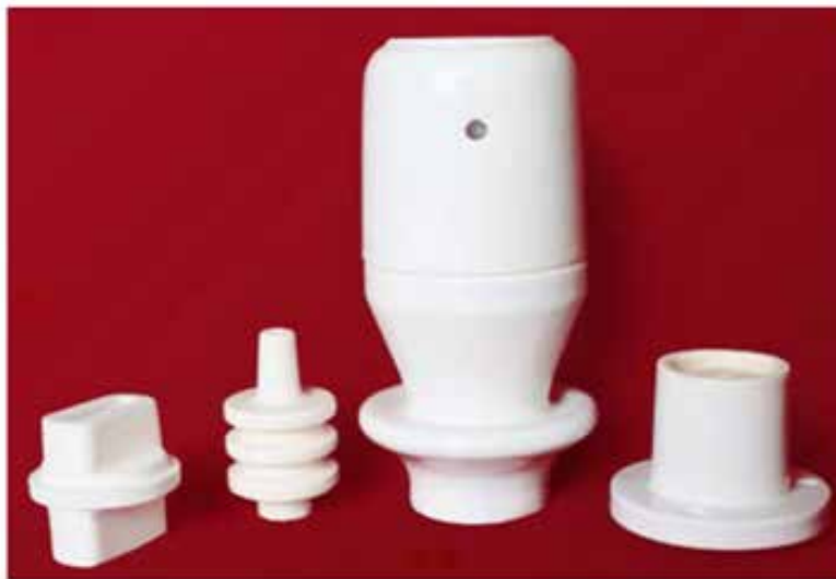
รูปที่ 6 อะลูมินาที่ใช้เป็นฉนวนไฟฟ้า
