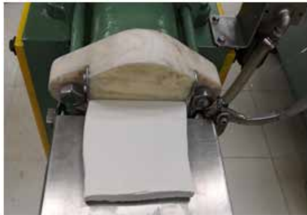
ชิ้นงานขณะอัดรีดผ่านหัวแม่แบบ
