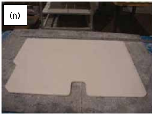
รูปที่ 3 เกราะกันกระสุนเนื้ออะลูมินาสำหรับรถตำรวจ (ก) แผ่นอะลูมินา และ (ข) ประตูลงตัวรถที่ทำจากอะลูมินา
