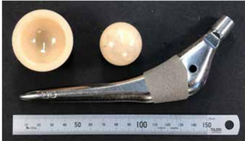
รูปที่ 1 alumina ball และ cup สำหรับการเปลี่ยนข้อต่อสะโพก
