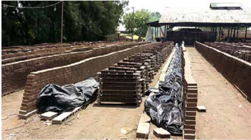
รูปที่ 6 การตากอิฐดิบกลางแจ้ง ตำบลมหาพราหมณ์ อำเภอบางบาล จังหวัดพระนครศรีอยุธยา
