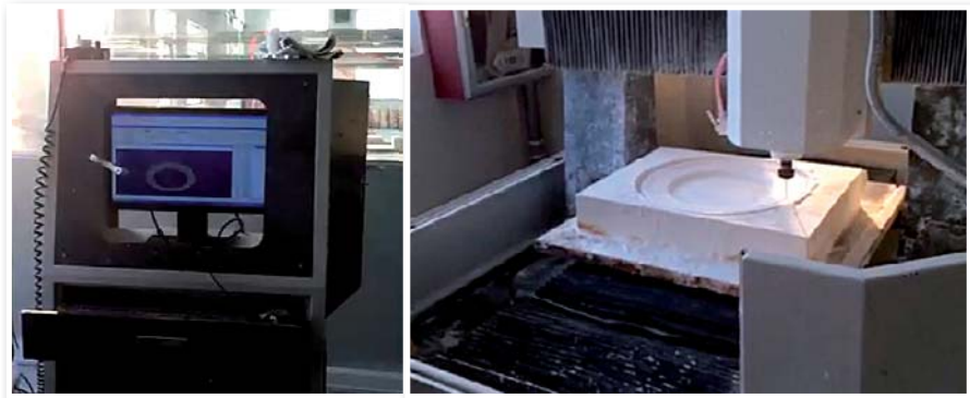
ภาพที่ 3. การควบคุมการสร้างโมเดลด้วย CNC Machine
