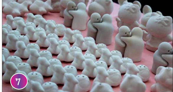
7 หลังจากแกะชิ้นงานออกจากแม่พิมพ์แล้ว ตั้งทิ้งไว้ให้แห้งสนิท จึงนำไปอบไล่น้ำออกเพื่อเพิ่มความแข็งแรง และลดความเสี่ยงที่จะทำให้เกิดการแตกร้าว ต่อจากนั้นนำไปเผาที่อุณหภูมิ 1,050^{\circ}\text{C} เพื่อเพิ่มความแข็ง
