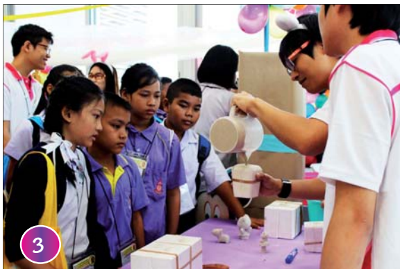
3 เทน้ำดินลงในแม่พิมพ์ที่ทำจากปูนปลาสเตอร์จนเต็ม
