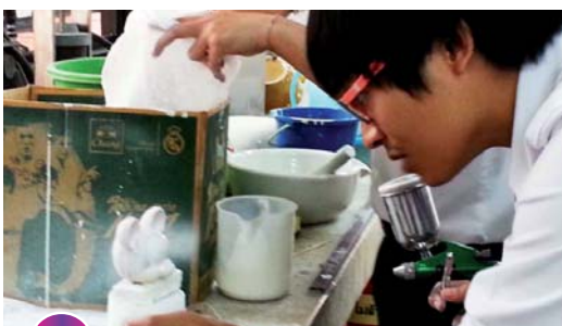
9 นำชิ้นงานมาเคลือบด้วยเคลือบใส เพื่อให้มีความมันวาว
