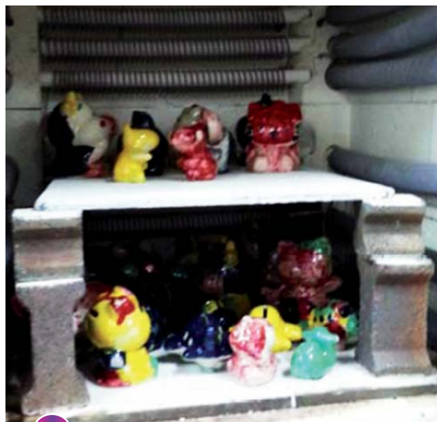
11 ขั้นตอนสุดท้ายคือนำไปเผาเคลือบอีกครั้งรอบ ที่อุณหภูมิ 1,050°C เพื่อให้เคลือบติดคงทนอยู่บนชิ้นงาน ได้สีสันทามลวดลายที่ตกแต่งไว้
