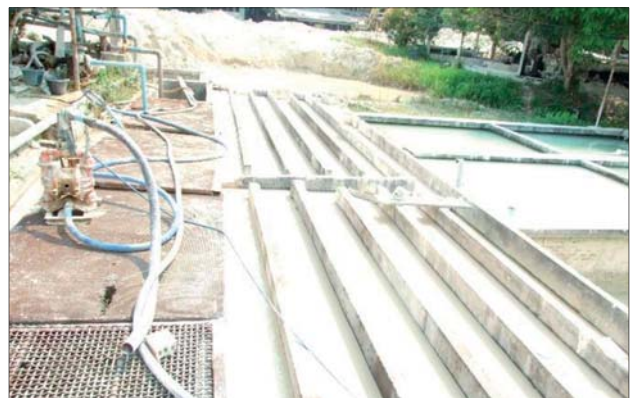
2. รูปกระบวนการล้างดินแบบรางซิกแซก และบ่อตกตะกอนดิน
