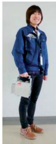
รูปที่ 10 เซลล์เชื้อเพลิงแบบท่อระดับไมโครเมตรแบบพกพาที่ใช้ LPG เป็นเชื้อเพลิงพัฒนาต้นแบบขึ้นโดย National Institute of Advanced Industrial Science and Technology (AIST) [14]
