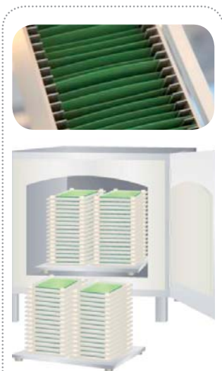
รูปที่ 6 เซลล์เชื้อเพลิงของแข็งออกไซด์แบบแผ่นของบริษัท Topeso Fuel Cell ประเทศเดนมาร์ก ซึ่งเตรียมแผ่นรองด้วยการหล่อเทป (tape casting) และเคลือบพื้นผิวแอโนดอิเล็กโทรไลต์และแคโทดตามลำดับและนำไปเผาขึ้น [6]
