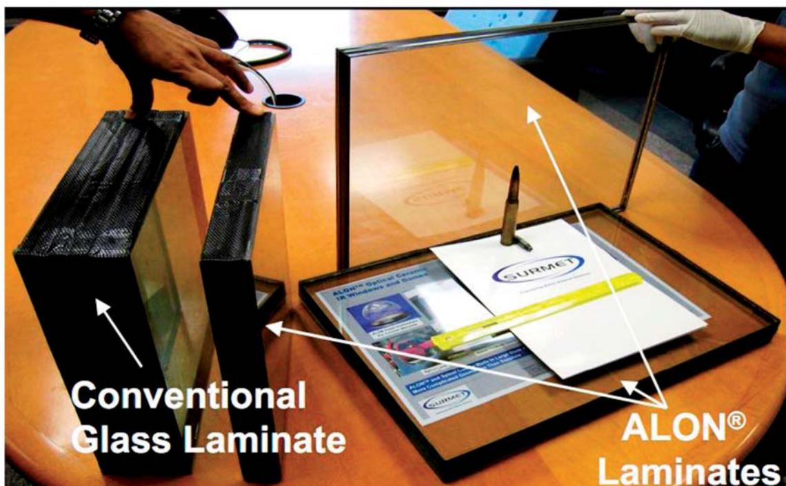
เปรียบเทียบขนาดของเกราะใสกันกระสุนที่ทำจากกระจกธรรมดากับเกราะใสที่ทำจากเซรามิกใส [1]
