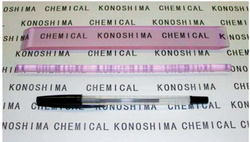
ตัวกำเนิดแสงเลเซอร์ที่ทำจากเซรามิกใส [4]
