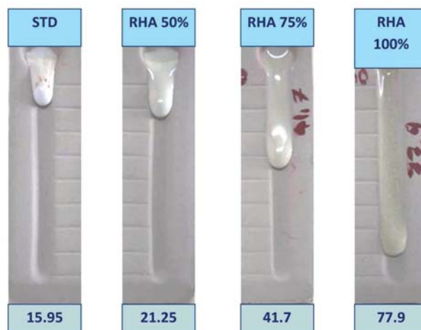
รูปที่ 6 การไหลตัวของเคลือบเมื่อนำไปเผาที่อุณหภูมิ 1250 องศาเซลเซียส ของสูตรเคลือบสโตนแวร์มาตรฐานและที่มีเถ้าแกลบผสมอยู่ 50, 75 และ 100 เปอร์เซ็นต์ตามลำดับ
