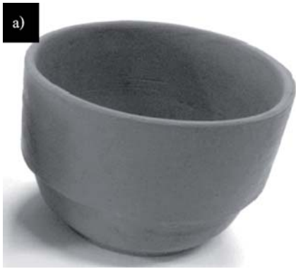
รูปที่ 9 ชิ้นงานรูปถ้วย a) ถ้วยเคลือบบดละเอียด (ก่อนเผา) b) ถ้วยเคลือบที่ผสมด้วยสโปดุมิน (หลังเผา)
