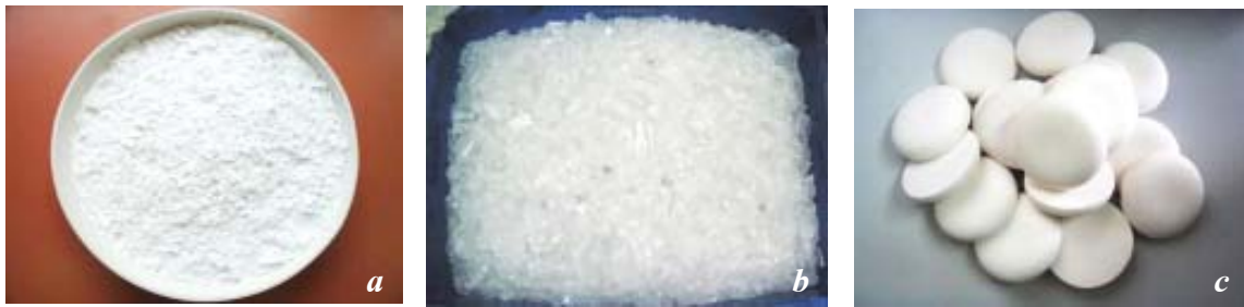
ภาพที่ 1 วัสดุเหลือทิ้งที่นำมาใช้ในการวิจัย a) เปลือกไข่ไก่แคลไซต์ b) เศษแก้วโบโรซิลิเกต c) เศษบิสกิตเซรามิก
