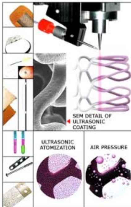
รูปที่ 3 แสดงการเคลือบผิวด้วยเทคนิคอัลตราโซนิคสเปรย์ในการแพทย์ [4]
