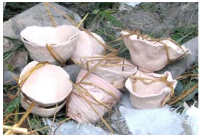
การตกแต่งภาชนะก่อนนำเข้าเตาเผาโดยวิธีเอนโกบและใช้ฟางข้าว
