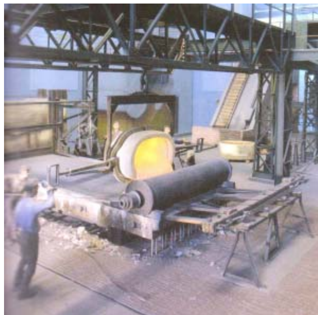
รูป 3 การผลิตแก้วแผ่นด้วยวิธี Table rolling process [3]
