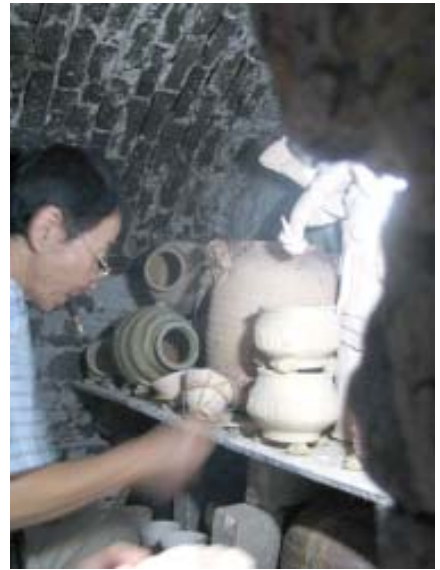
การนำภาชนะเรียงเข้าภายในเตาเผาต้องใช้ดินทนไฟหรือเปลือกหอยแครงช่วยเวลาติดตั้งงาน
