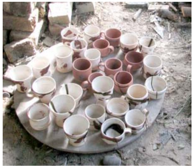
การตกแต่งภาชนะก่อนนำเข้าเตาเผาโดยวิธีเอนโกบและใช้ฟางข้าว
