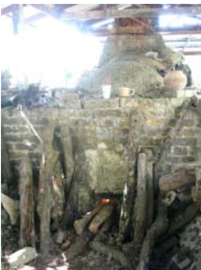
การสูมหั่วเตาบริเวณช่องเผาด้านล่างและการตัดพินให้พร้อมสำหรับการเผา
