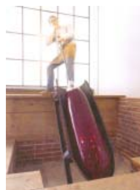
รูป 1 การผลิตแก้วแผ่นด้วยวิธี Cylinder process [3]
