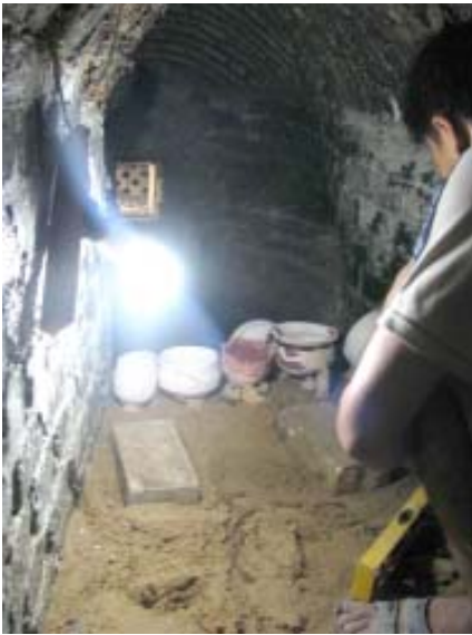
การนำภาชนะเรียงเข้าภายในเตาเผาต้องใช้ดินทนไฟหรือเปลือกหอยแครงช่วยเวลาติดตั้งงาน
