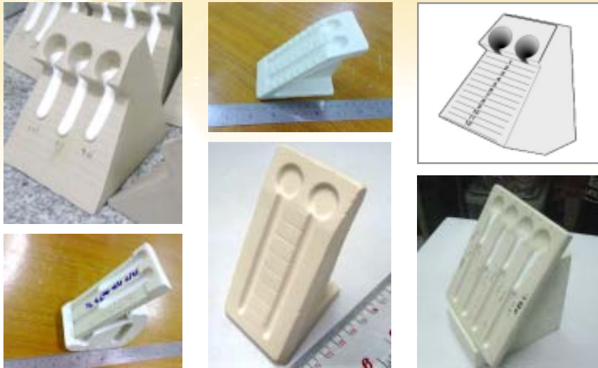
รูปที่ 2 ตัวอย่างอุปกรณ์ทดสอบด้วยวิธี Inclined flow plane test ที่ใช้ในอุตสาหกรรมเซรามิก
