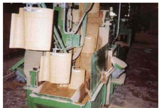
การเคลือบกระเบื้องหลังคาแบบจุ่ม
