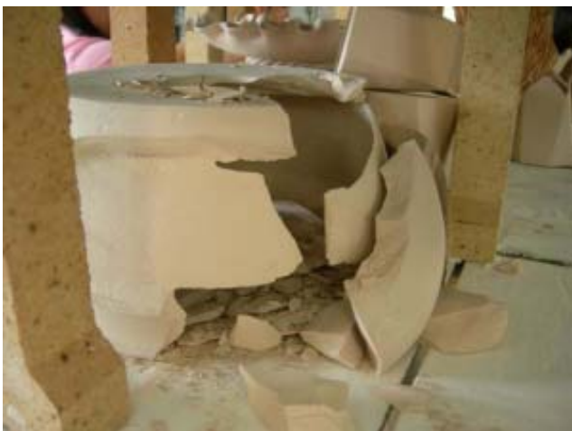
กระถางระเบิดหลังเผาบิสกิตจากความหนาที่มากเกินไป
