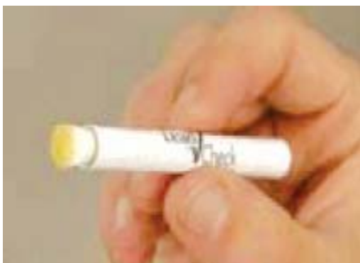
ภาพตัดอุปกรณ์ตรวจสอบพื้นผิวปนเปื้อนตะกั่ว (ภาพจาก www.leadtestkits.com/kits4.html )
