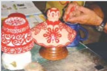
ภาพที่ 2 ขั้นตอนการตกแต่งบนชิ้นงาน เผาดิบ (Biscuit) ก่อนทำการพ่น
