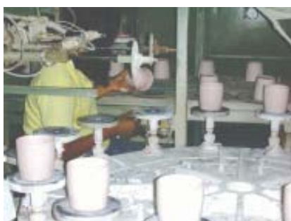
ตกแต่งปากถ้วยหลังจักเกอร์
