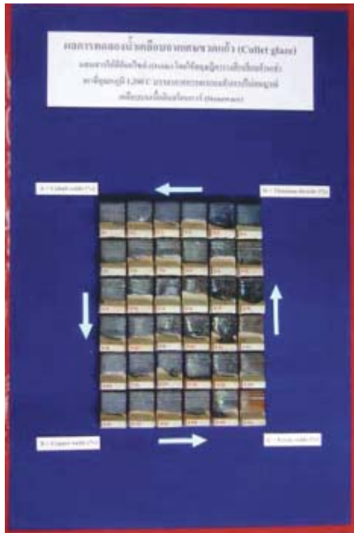
ภาพที่ 3 แสดงลักษณะของเคลือบหลังเผาบรรยากาศการเผา แบบสันดาปไม่สมบูรณ์ (Reduction firing) ในการทดลองขั้นตอนที่ 2
