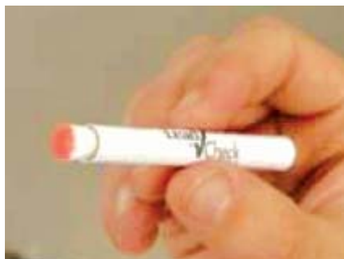
ภาพตัดอุปกรณ์ตรวจสอบพื้นผิวปนเปื้อนตะกั่ว (ภาพจาก www.leadtestkits.com/kits4.html )
