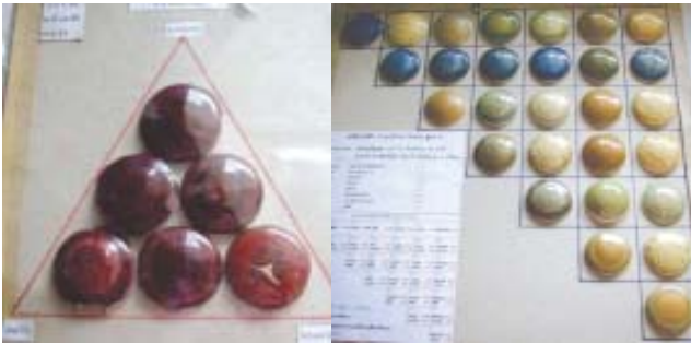
ภาพการทดลองหาสูตรเคลือบอย่างง่าย โดยใช้ทฤษฎีตารางสามเหลี่ยมและการคำนวณสูตรเซเกอร์
