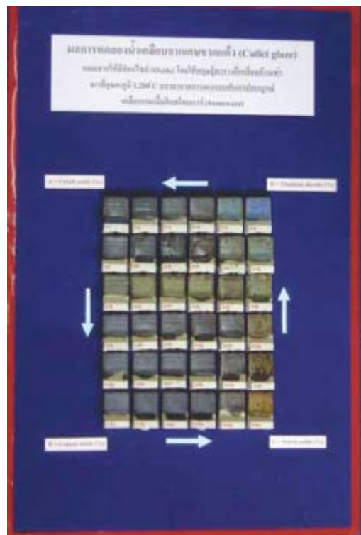
ภาพที่ 2 แสดงลักษณะของเคลือบหลังเผาบรรยากาศการเผา แบบสันดาปสมบูรณ์ (Oxidation firing) ในการทดลองขั้นตอนที่ 2
