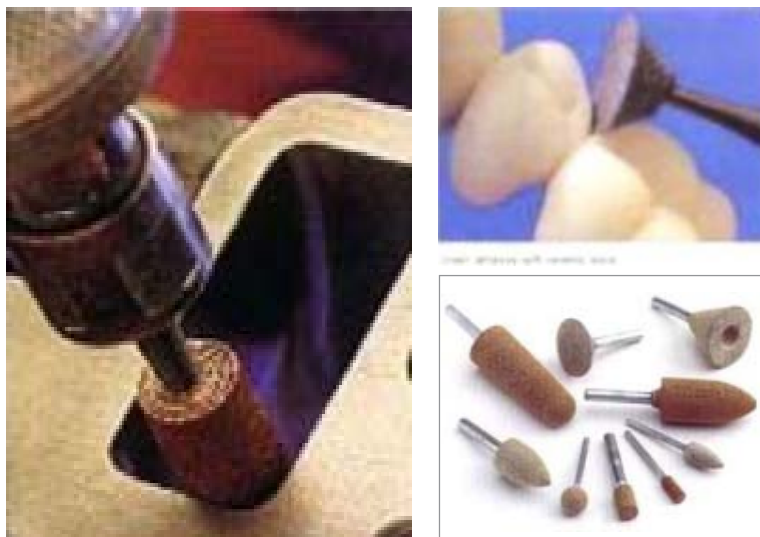
รูปที่ 6 วัสดุขัดถูขนาดเล็ก หรือเบอส์ (Burs)
