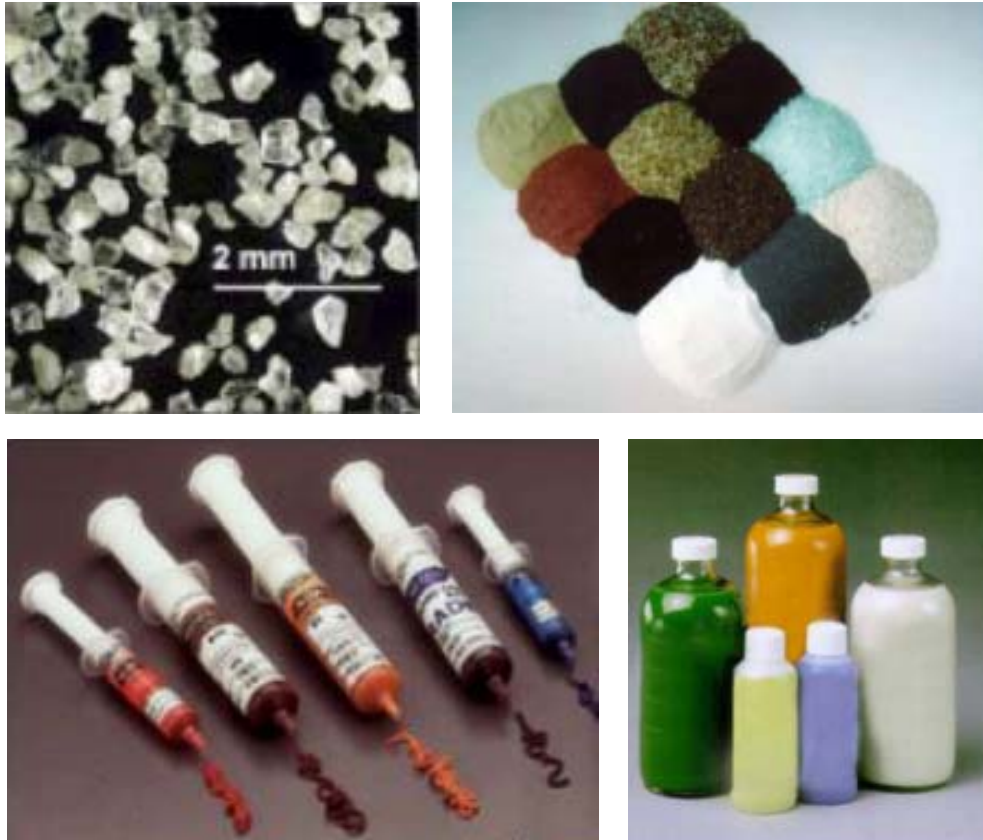
รูปที่ 7 วัสดุขัดถูสำหรับงานขัดผิวละเอียด (Lapping compound)
