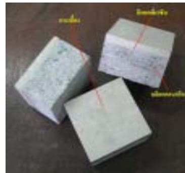
รูปที่ 4 เครื่องทดสอบความต้านทานการกระแทก และตัวอย่างกระเบื้องบนบล็อกคอนกรีต
