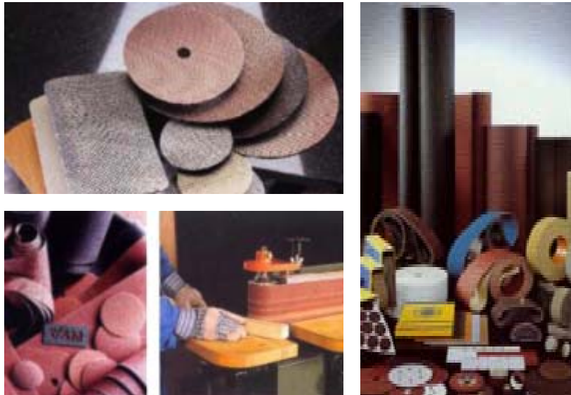
รูปที่ 3 วัสดุขัดถูชนิดเคลือบ (Coated abrasives)
