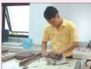
การขึ้นรูปด้วยการรีดเป็นแผ่นและใช้แม่พิมพ์เป็นแบบในการขึ้นรูป
