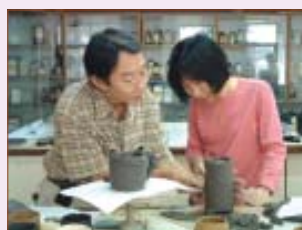
การขึ้นรูปด้วยการรีดเป็นแผ่นและใช้แม่พิมพ์เป็นแบบในการขึ้นรูป
