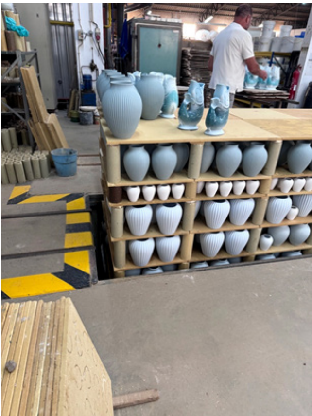
ภาพที่ 5 โปรแกรมการไปเยี่ยมชมโรงงานต่างๆ ที่อยู่ในเมืองทั้งสอง ผู้เขียนรู้สึกประทับใจรถเตาที่ลดระดับลงไปในพื้นที่เหมือนลิฟต์ เพื่อให้โหลดชิ้นงานได้ง่ายไม่ต้องเอื้อมสูง เมื่อโหลดครบจึงค่อยๆ เลื่อนขึ้นให้ได้ระดับรางแล้วเคลื่อนเข้าไปในเตา
