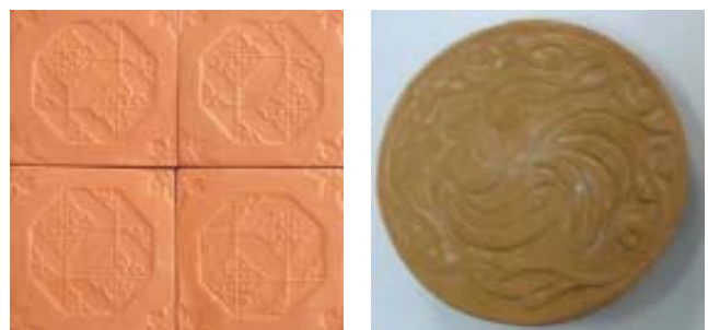
รูปที่ 2 ชิ้นงานหลังเผาที่ 1000 °C (แบบไม่เคลือบ)
