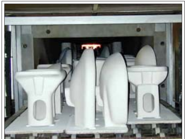
เตาโรลเลอร์ที่ใช้เผาเครื่องสุขภัณฑ์ สามารถเผาเร็วและประหยัดพลังงาน
