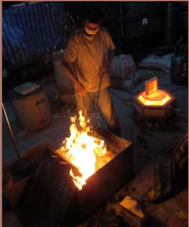
ภาพที่ 7 เปิดเตาออกเมื่อเผาถึงอุณหภูมิที่ต้องการ และใช้คีมคีบชิ้นงานออกมาใส่ในวัสดุใหม่ไฟ
