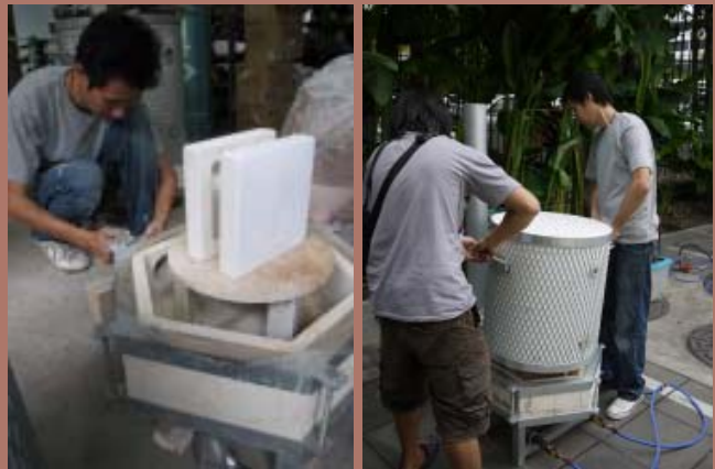
ภาพที่ 5-6 เตาขนาดเล็กใช้เชื้อเพลิงจากแก๊สสูงต้มใช้งานได้ง่ายโดยคนเพียง 2 คน
