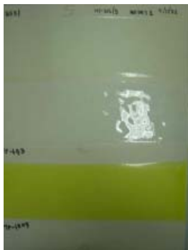
ภาพแสดงผลของฟritต่อสีเสเตนสีเหลือง (Pr-Zr-Si)
