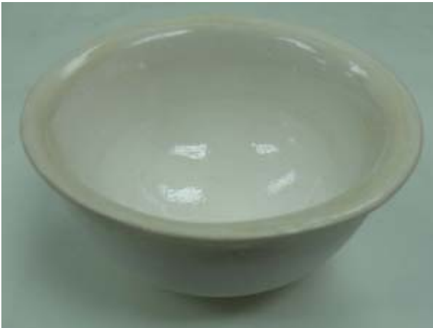
รูปที่ 3 ชิ้นตัวอย่างที่ชุบน้ำเคลือบสูตรที่ 1 หลังเผาที่อุณหภูมิ 1050 °C
