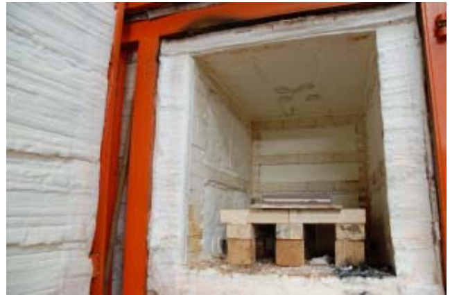
เตาทดลองของโรงงานที่ผ่านการใช้งานเพื่อการพัฒนาผลิตภัณฑ์มาอย่างโชกโชนแต่นี้ดัดแปลงมาจากเตาไฟฟ้าให้เป็นเตาใช้ LPG ในปัจจุบัน
