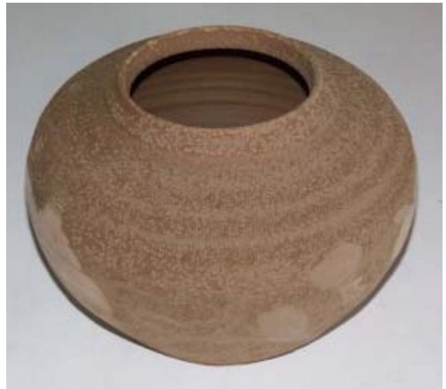
รูปที่ 2 เนื้อดินปั้นพิเศษที่เมื่อเผาแล้วมีเคลือบในตัว หลังจากอบแห้งก่อนนำไปเผา
