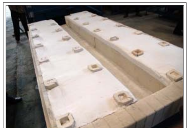
รถเตาเผามวลเบา เสารับน้ำหนักชั้นวาง ตั้งบนโครงเหล็กรถเตา
