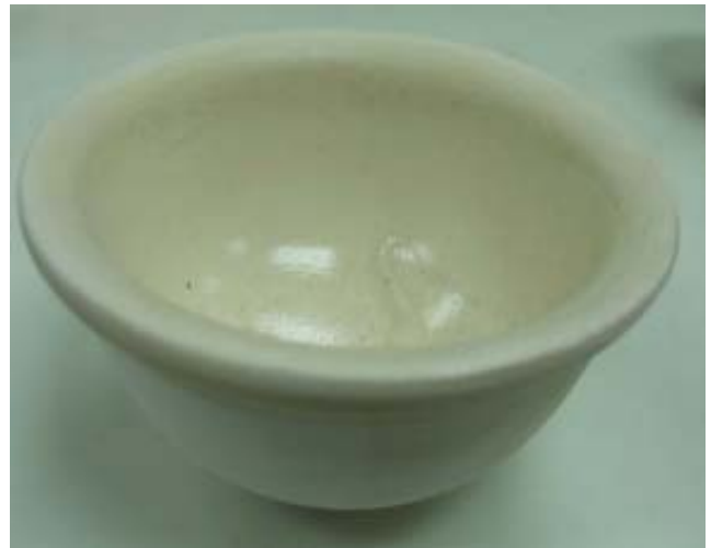
รูปที่ 5 ชิ้นตัวอย่างที่ชุบน้ำเคลือบสูตรที่ 3 หลังเผาที่อุณหภูมิ 1050 °C
