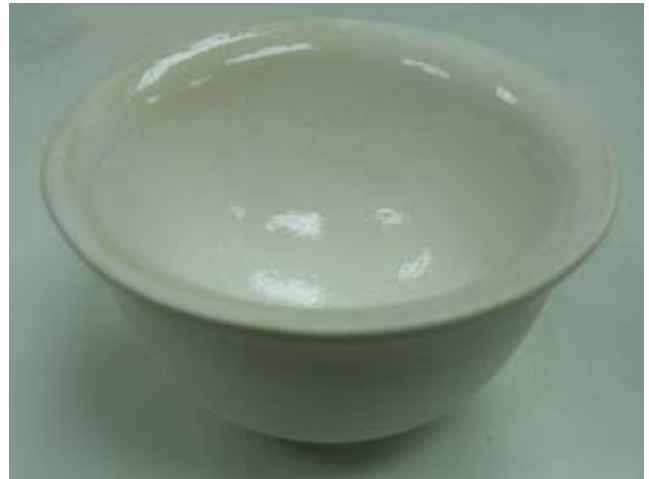
รูปที่ 4 ชิ้นตัวอย่างที่ชุบน้ำเคลือบสูตรที่ 2 หลังเผาที่อุณหภูมิ 1050 °C
