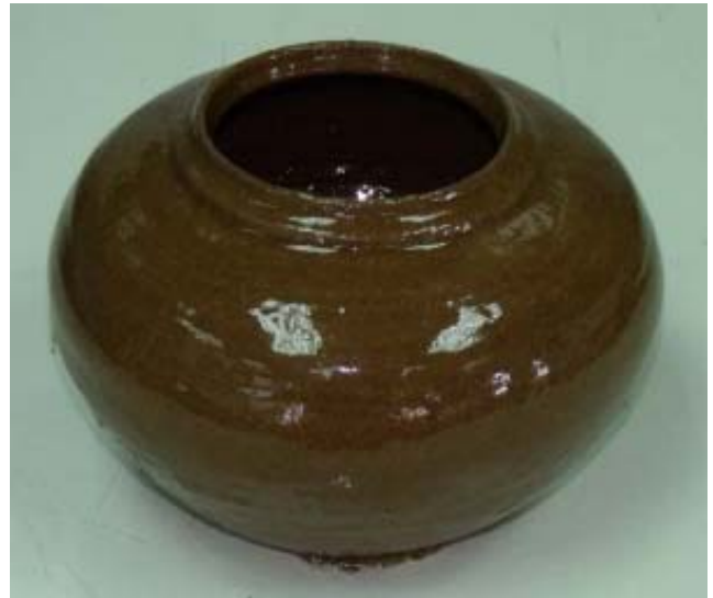
รูปที่ 1 เนื้อดินปั้นพิเศษที่เมื่อเผาแล้วมีเคลือบในตัว หลังเผาที่ 1000 °C ยืนไฟ 2 ชั่วโมง
