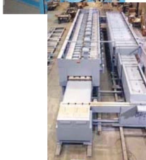
เตาชนิดต่อเนื่องแบบใช้พุทเซอร์ในการลำเลียงผลิตภัณฑ์
