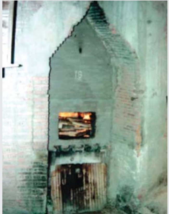
ภาพที่ 7 ลักษณะของอิฐที่วางอยู่ในเตาเผาทำหน้าที่เป็นตะกรับเตา
