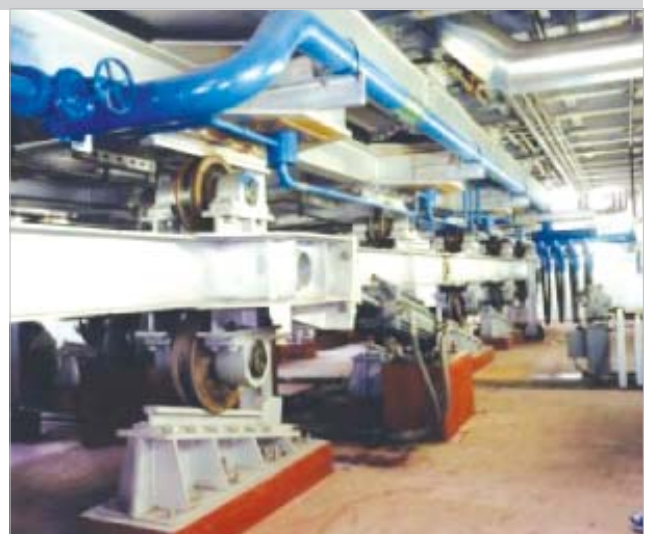
เตาชนิดต่อเนื่องแบบใช้วอล์กทิวบ์ในการลำเลียงผลิตภัณฑ์
