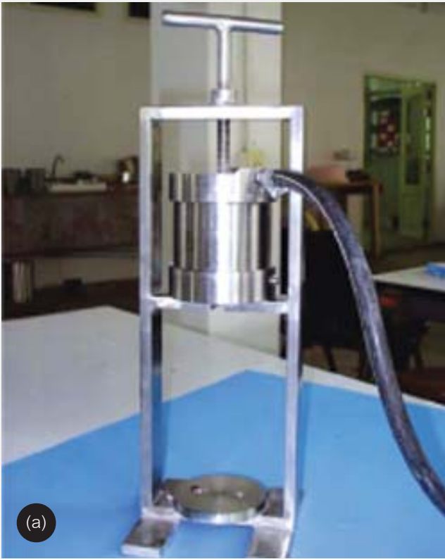
ภาพที่ 2 (a) เครื่อง Baroid filter press เมื่อประกอบเสร็จแล้ว (b) เครื่อง Baroid filter press เมื่อถอดประกอบแยกส่วน
