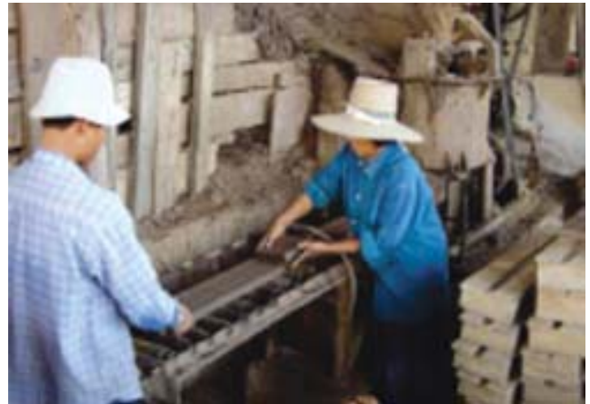
ภาพที่ 4 การทำอิฐในลักษณะใหม่โดยใช้เครื่องอัดดิน
