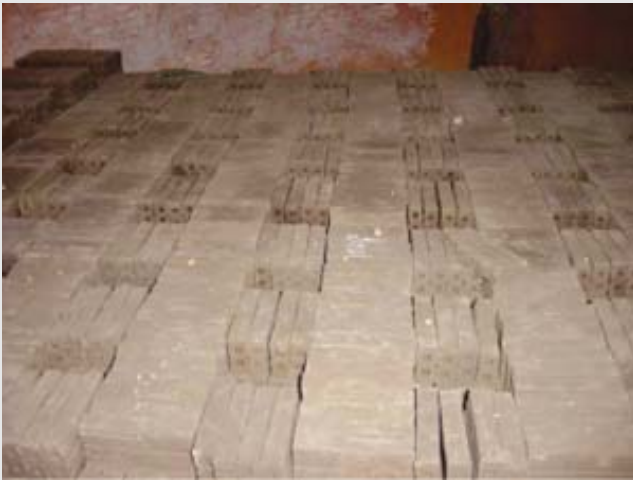
ภาพที่ 7 ลักษณะของอิฐที่วางอยู่ในเตาเผาทำหน้าที่เป็นตะกรับเตา
