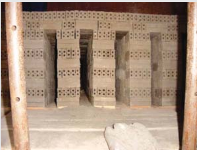
ภาพที่ 8 บริเวณด้านหน้าของเตา อิฐจะเรียงเป็นตะกรับในแนวตั้ง
