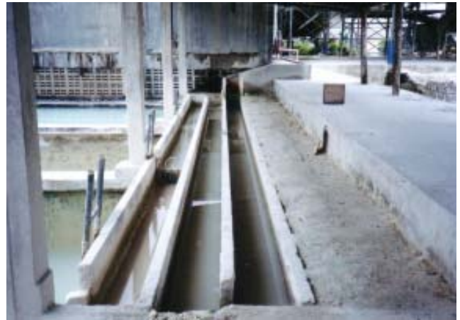
รางซึกแห้งสำหรับแยกทรายออกจากดินขาว
