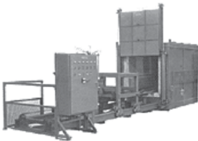
เตาชนิดไม่ต่อเนื่องแบบป้อนด้านหน้า
